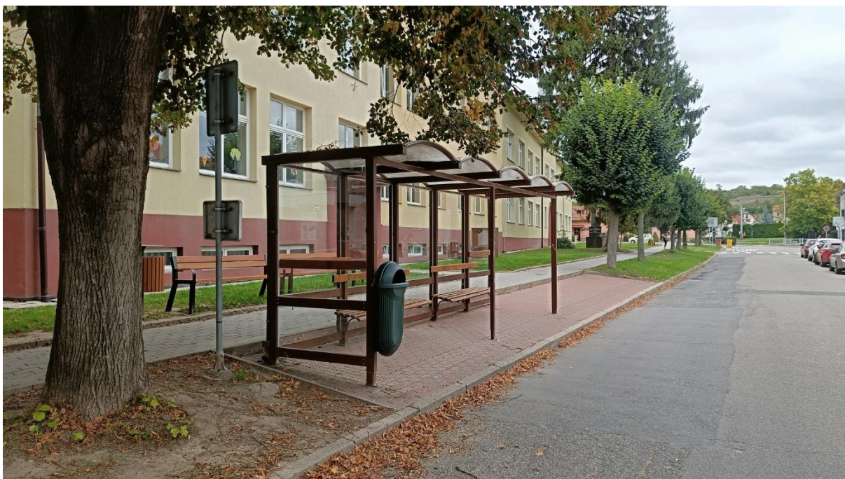
Obr. 9: Autobusová zastávka Újezd u Brna, škola bez zvýšené nástupní hrany. Zastávka není bezbariérově napojena na pěší infrastrukturu.
