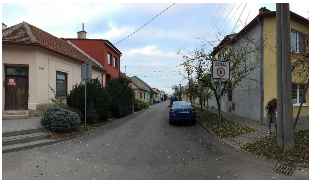
Obr. 17 – Vjezd do ulice Legionářská z ulice Tyršova, začátek zóny 30 v severní části města (dopravní značka IZ 8a – zóna s dopravním omezením)
