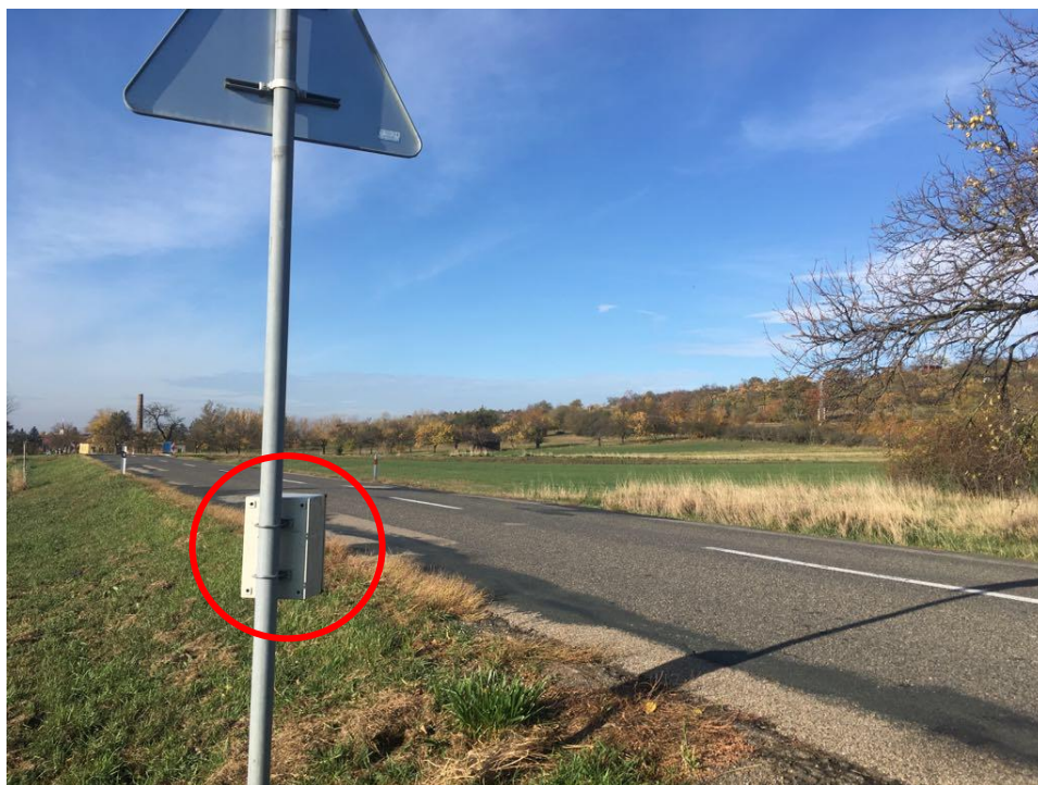
Obr. 65 – Radar na lokalitě 4 byl umístěn na silnici II/416 na dopravní značce A2A – dvojitá zatáčka, první vpravo
